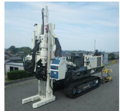
写真-1 専用貫入装置の一例
